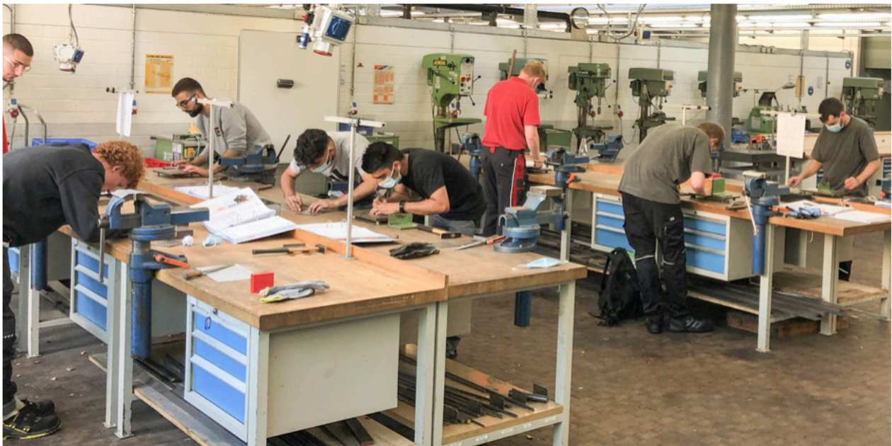
Metallwerkstatt: Auszubildende reißen zu bearbeitende Teile an.
