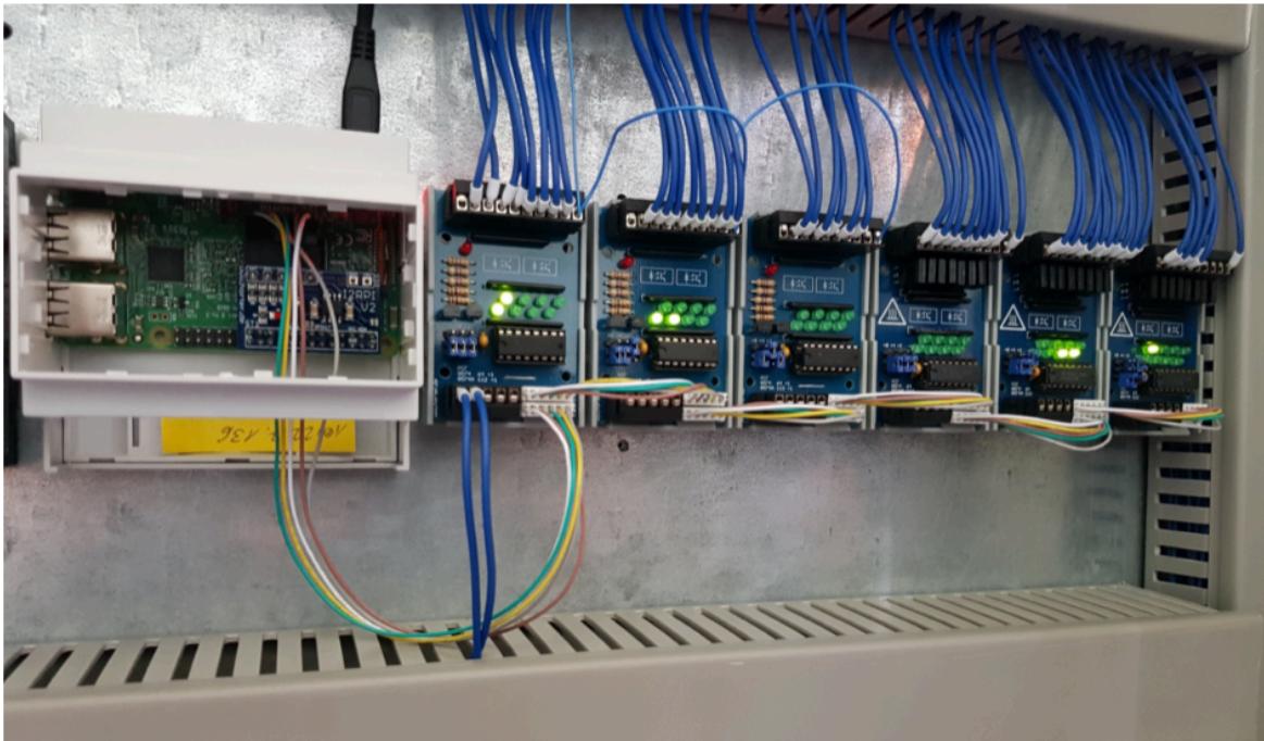
Industrie 4.0 im Einsatz: Der Single Board Computer, Raspberry Pi (links), verbunden mit elektronischen Steuermodulen über I2C-Bus.
